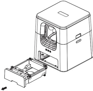
Ziehen Sie die Auffangschublade aus der Basis der CleanMe heraus
