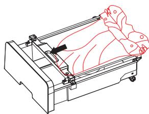
Verschieben Sie die Versiegelungsleiste, um den Auffangbeutel zu lösen
