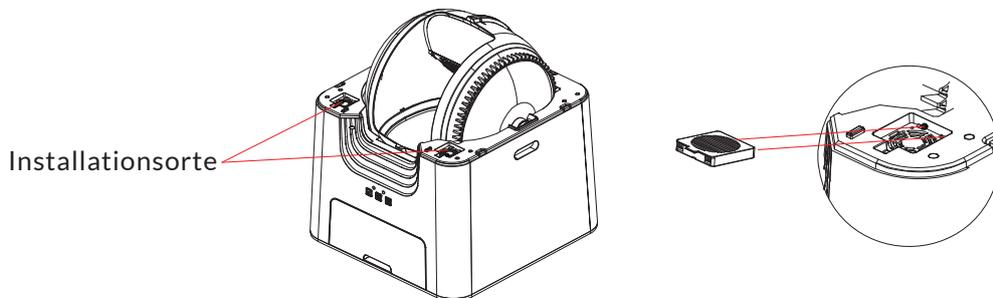
2. Richten Sie die Dufteinsätze an den Montageschlitten aus und drücken Sie sie, bis Sie ein „Klick“-Geräusch hören, das anzeigt, dass sie sicher angebracht sind.
