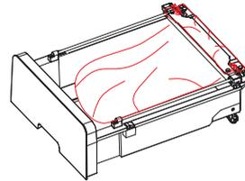
Entfernen Sie vorsichtig den Beutel, indem Sie seine vier Löcher von den vier Stiften an der Auffangschublade lösen
