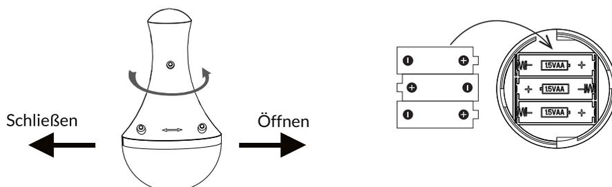
3. Montieren Sie die Basis wieder am Gehäuse;
